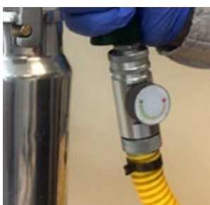
Regulador de producto mediante ruleta con indicador de flujo
